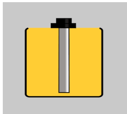
Рис. 21 Заполнение трубок погружением датчика в топливо (дренажные отверстия открыты)
