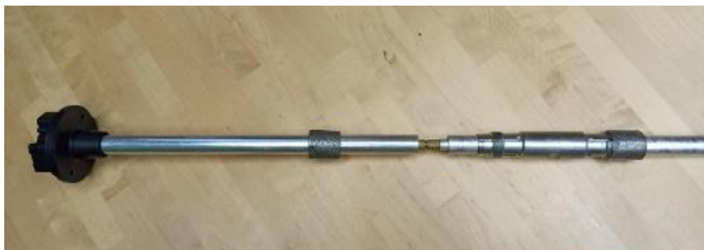
Рис. 41 Цанговое соединение. Наружнее соединение
