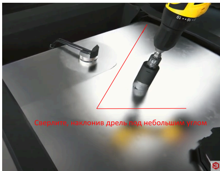
Рис. 33 Сверление отверстия под углом
