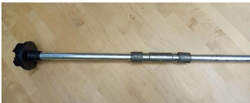
Рис. 42 Цанговое соединение установлено
