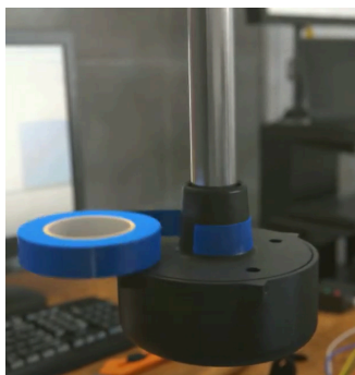
Рис. 20 Закрытие дренажных отверстий, переворачивание датчика и заполнение трубок топливом
