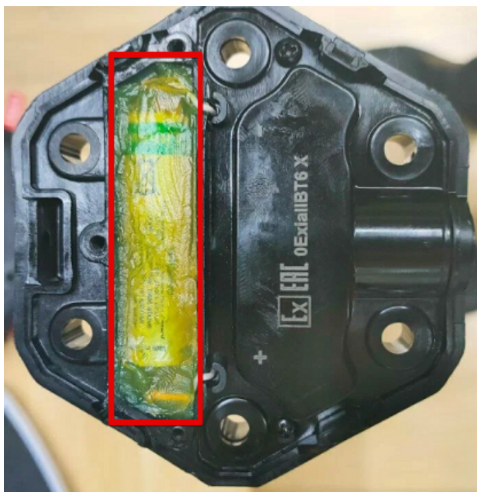
Рис. 98 Полость держателя батарейки, залитая литолом
