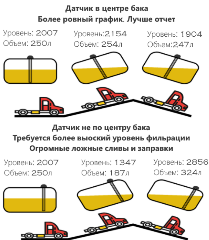
Рис. 35 Положение датчика и перетекание топлива
