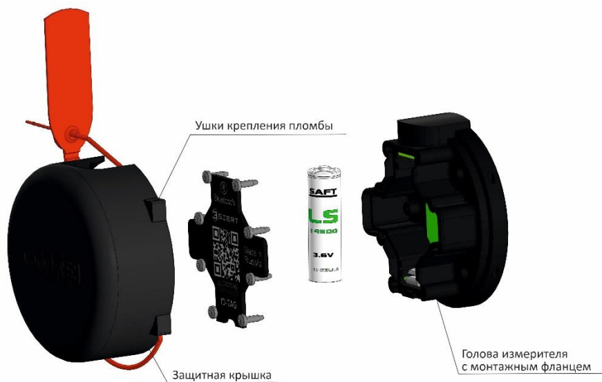
Рисунок 1 – Конструкция беспроводного датчика угла с автономным питанием ЭСКОРТ DU-BLE исполнения 1,2
