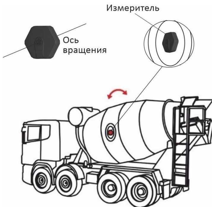
Рисунок 20 – Размещение DU-BLE на бетоносмесителе в режиме горизонтального вращения
