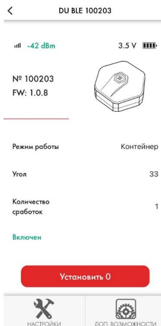
Рисунок 40– Отображение текущих данных датчика в режиме «Контейнер»
