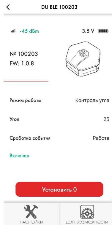
Рисунок 38 – Отображение текущих данных датчика в режиме «Контроль угла»
