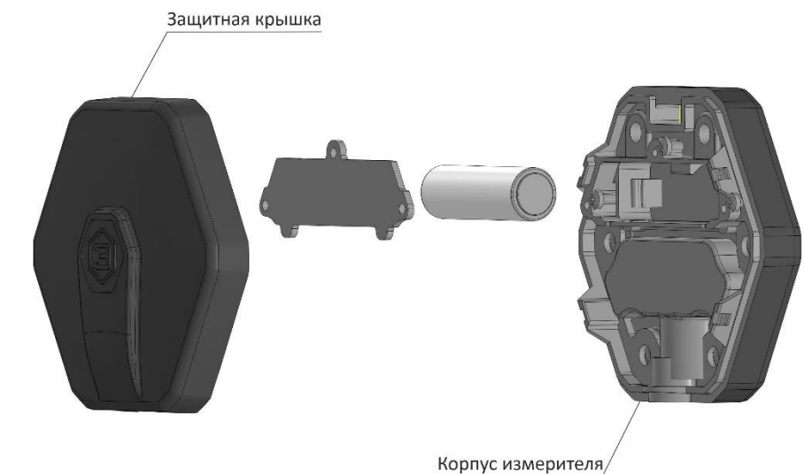
Рисунок 1 – Конструкция беспроводного датчика угла с автономным питанием ЭСКОРТ DU-BLE исполнения 1,2
